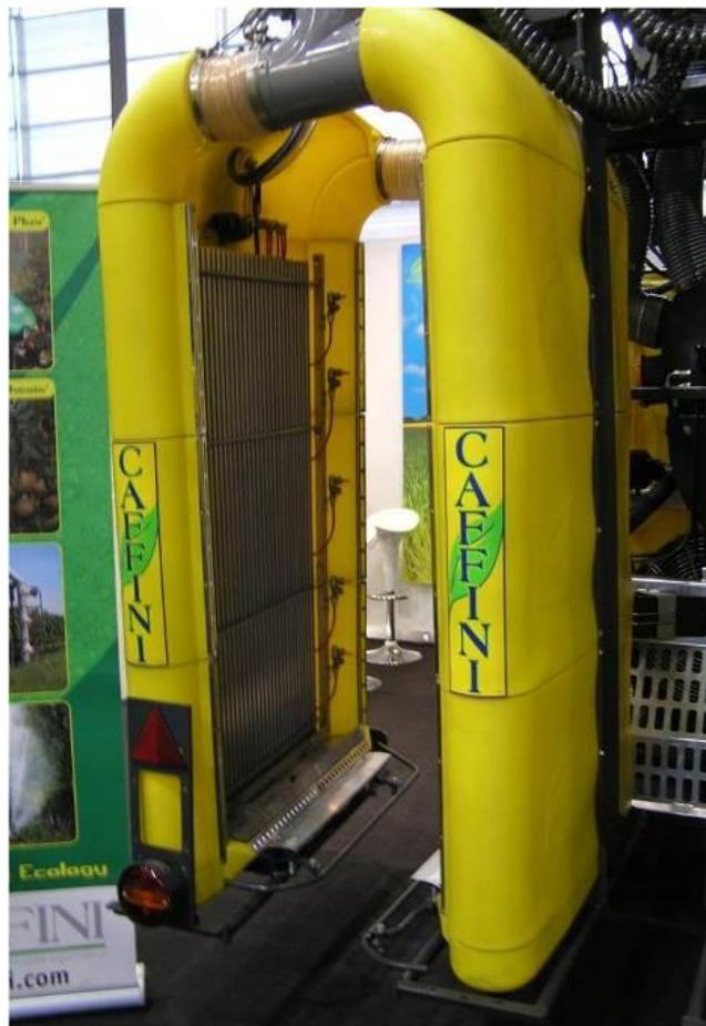
Slika 13.26: Tunelski stroj za tretiranje vinograda i niskih nasada voćnjaka
