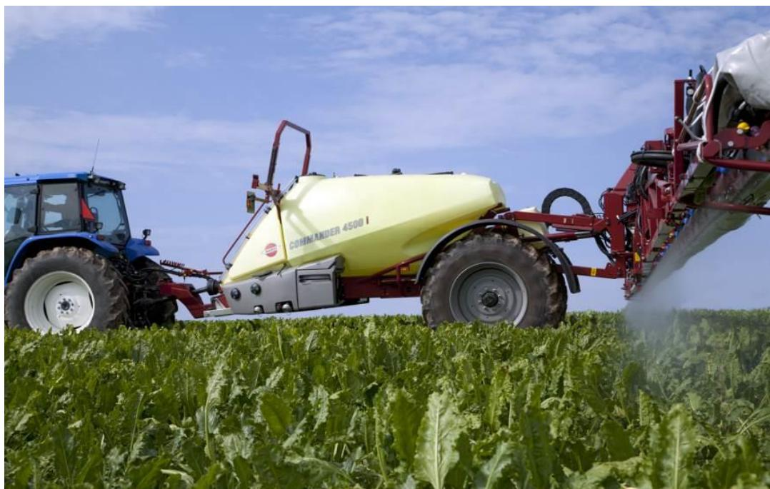
Slika 13.23: Prskalica sa zračnom potporom "HARDI TWIN" (izvor: [www.hardi-interacional.com](http://www.hardi-interacional.com))
