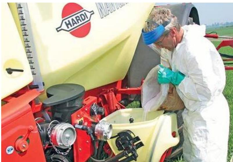
**Slika 13.16:** Punjenje spremnika stroja za primjenu korištenjem osobne zaštitne opreme
