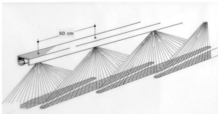
**Slika 13.4:** Preklapanje mlazeva pod kutom od 5° do 10° (izvor: [www.findri.hr](http://www.findri.hr))
