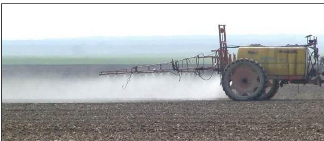
**Slika 13.22:** Zanošenje, tj. odnošenje kapljica tijekom rada prskalice
