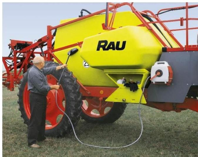
**Slika 13.33:** Pranje prskalice izvana na površini gdje je obavljeno tretiranje
