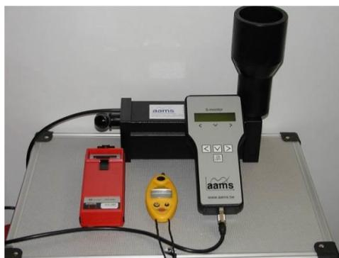
**Slika 13.5:** Elektronski mjerač protoka tvrtke "AAMS"
