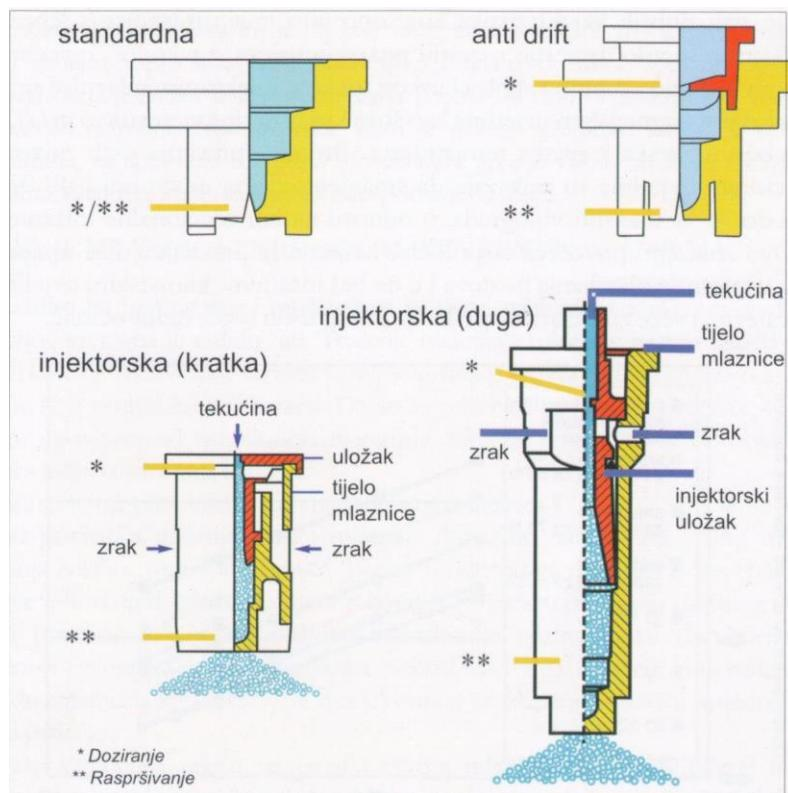
Slika 13.12: Poprečni presjek mlaznica s lepezastim mlazom
